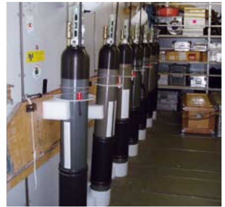
NEMO-Floats werden für das Aussetzen vorbereitet (Die aktuelle Version hat eine max. Tauchtiefe von 2000 m)
