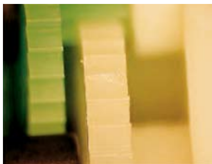
Typische Beschädigungen der Zahnräder
