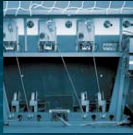
Kompakter, spurtstarker Antrieb per Seil und Riemen
