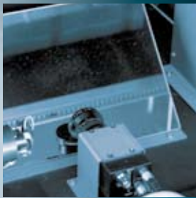
Spielfeld mit Beleuchtung und Filterfolie, die Kamera beobachtet von unten das Geschehen
