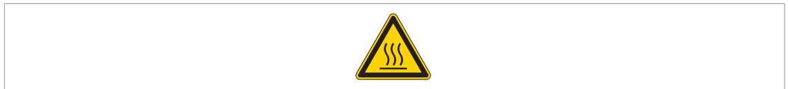
Fig. 1: Suitable warning sign acc. to DIN EN ISO 7010
