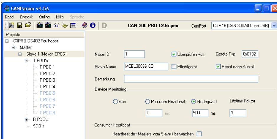
Die Daten der PDOs werden in der SPS im Eingangs- bzw. Ausgangsabbild ab EB50 und AB50 abgebildet.
