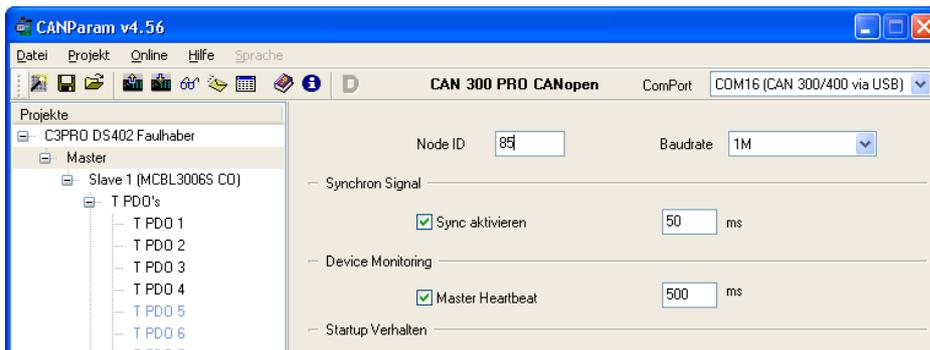
Die Faulhaber Steuerung wird über den Gerätetyp 0x0192 identifiziert. Der Gerätetyp wird beim Hochlauf des Masters ausgelesen (im Anwendungsbeispiel „Faulhaber MCBL3006S CO“).
