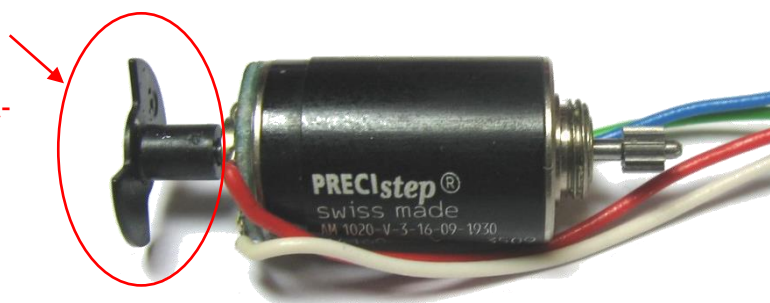
Image 2 : moteur avec une pièce plastique sur l'arrière de l'arbre utilisé pour une solution de codeur optique personnalisé.
