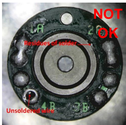
Figure 4 : bon et mauvais exemple d'une soudure sur différents moteur pas à pas.
