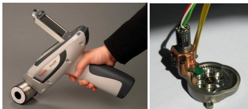
Image 15 : Analyseur à rayons-x portable (à gauche) et un exemple de roue filtrée intégrée au moteur pas à pas (à droite).
